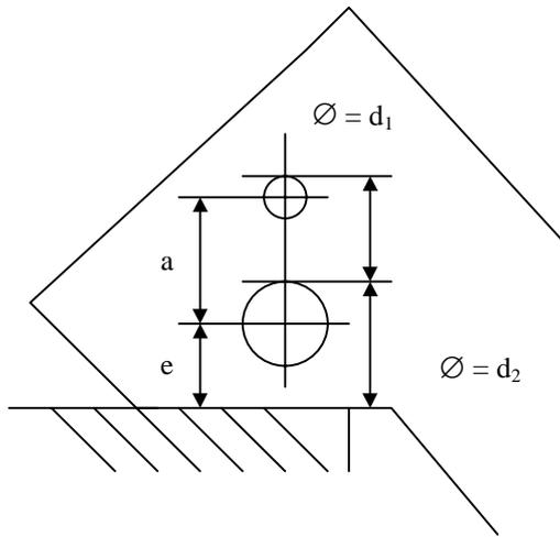
$d_1=10.01\text{mm}$   $d_2=12.01\text{mm}$  (micrometer)
